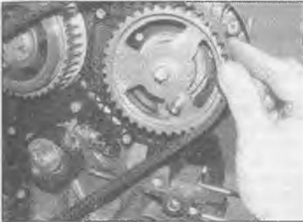
7.13b . . . inlet camshaft sprocket . . .
